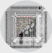
先进的Planar|CT评估,没有重叠特性的X射线影像
