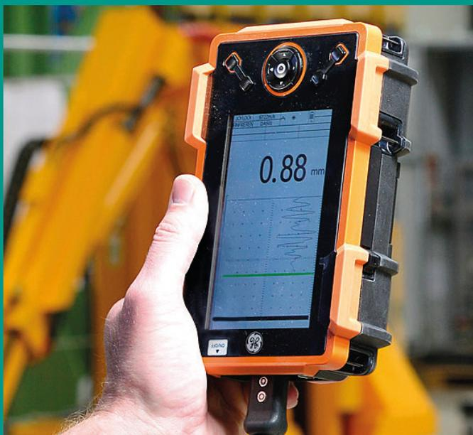
O Krautkrämer DMS Go+ oferece uma solução portátil abrangente para medição de espessura, registro de dados e gerenciamento de dados em uma ampla gama de aplicações e ambientes.
